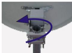
**8.4 Cas N° 3** - Si la qualité de l'image s'améliore en bougeant la parabole vers le HAUT aussi bien sur le satellite le plus à l'EST que celui à l'OUEST, dévisser les fixations du support du moteur et diminuer légèrement l'élevation du moteur et augmenter celle de la parabole par la même valeur. Resserrer les fixations. Vérifier la qualité de l'image sur les satellites EST et OUEST. S'il y a une amélioration, exécuter la suite de la procédure comme dans le cas n° 1.
