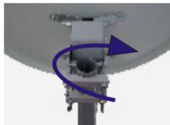
**8.3 Cas N° 2** - Si la qualité de l'image s'améliore en bougeant la parabole vers le HAUT sur le satellite le plus à l'OUEST et vers le BAS sur celui le plus à l'EST, dévisser les fixations du moteur du mât de support et tourner l'ensemble légèrement vers l'EST (sens contraire des aiguilles d'une montre). Resserrer les fixations. Vérifier la qualité de l'image sur les satellites EST et OUEST. S'il y a une amélioration, exécuter la suite de la procédure comme dans le cas n° 1.
